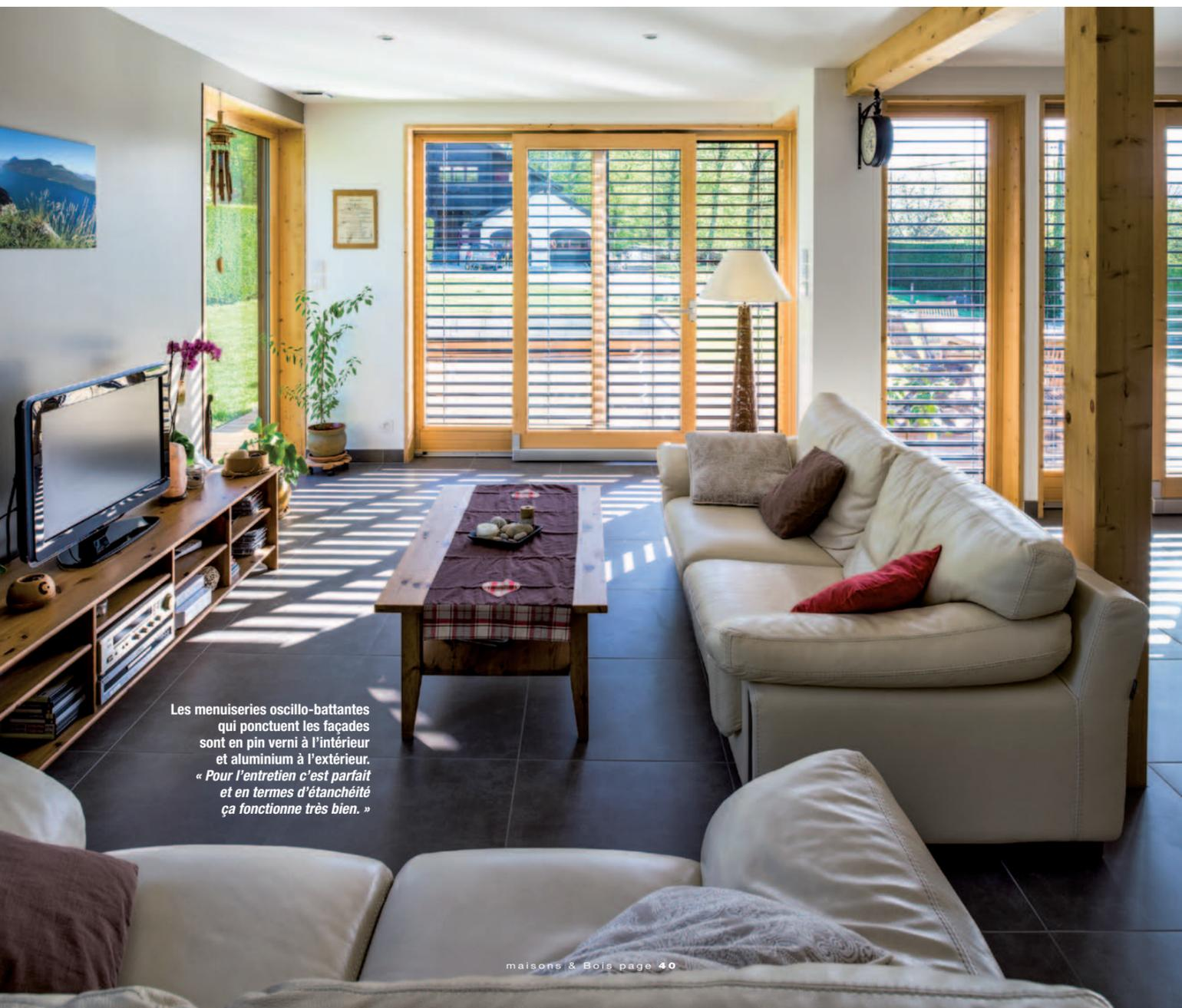
Les menuiseries oscillo-battantes qui ponctuent les façades sont en pin verni à l'intérieur et aluminium à l'extérieur. « Pour l'entretien c'est parfait et en termes d'étanchéité ça fonctionne très bien. »
